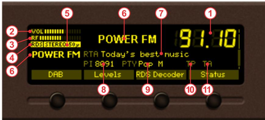
1. Indicador de frecuencia, que muestra la frecuencia seleccionada actualmente, en MHz;
