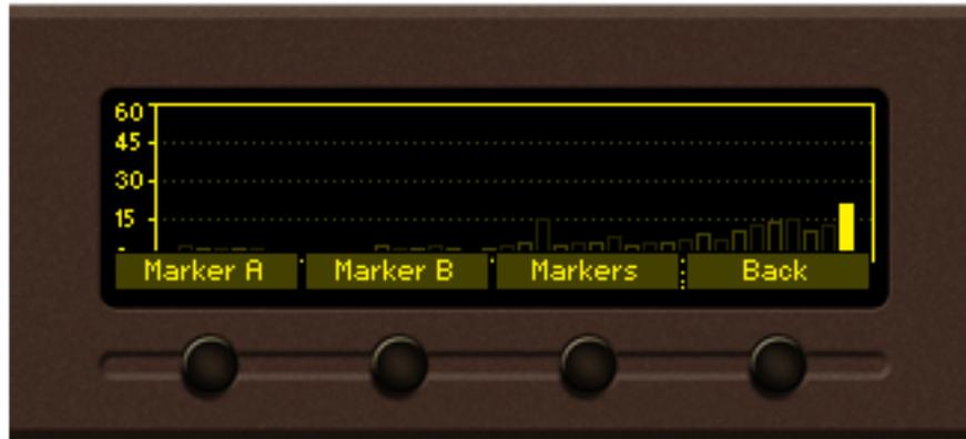
Por ejemplo: Cuando se selecciona el siguiente menú pulsando [SB3] cambiará la pantalla de Marcador a Control de Span y viceversa. Todas las etiquetas de los botones Soft cambiarán según el submenú. El estado de control de la página cambiará con cada pulsación de [SB3].
