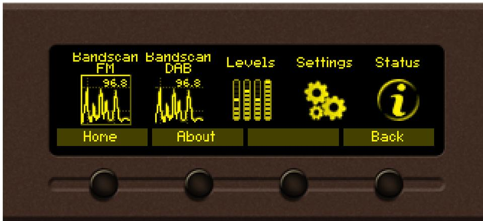
Pulse el botón [OK] para acceder a la sección “Status”. A través del menú de navegación del panel frontal, pulse el botón [ABAJO].
