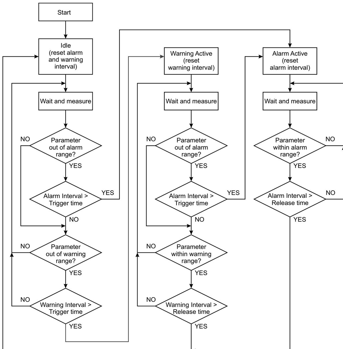
*Diagrama de Bloqueo del Automata de Alarma*
