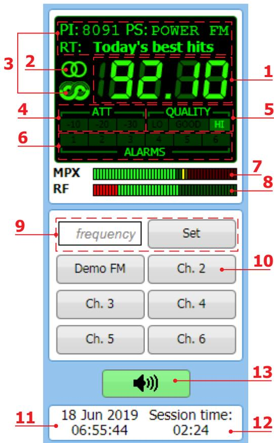
1. Indicador de Frecuencia mostrando la frecuencia actual sintonizada;
