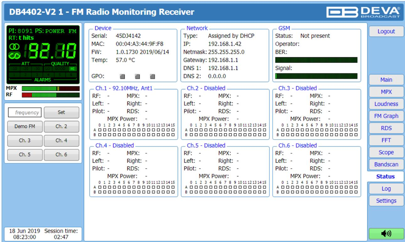
La pantalla de Estado muestra la alarma de estado de cada parámetro de las frecuencias preestablecidas, junto con el dispositivo básico y el estado de la red (Dirección IP, MAC, etc.). Si se conecta un módem GSM, el estado del módem también se describirá en la sección correspondiente.
