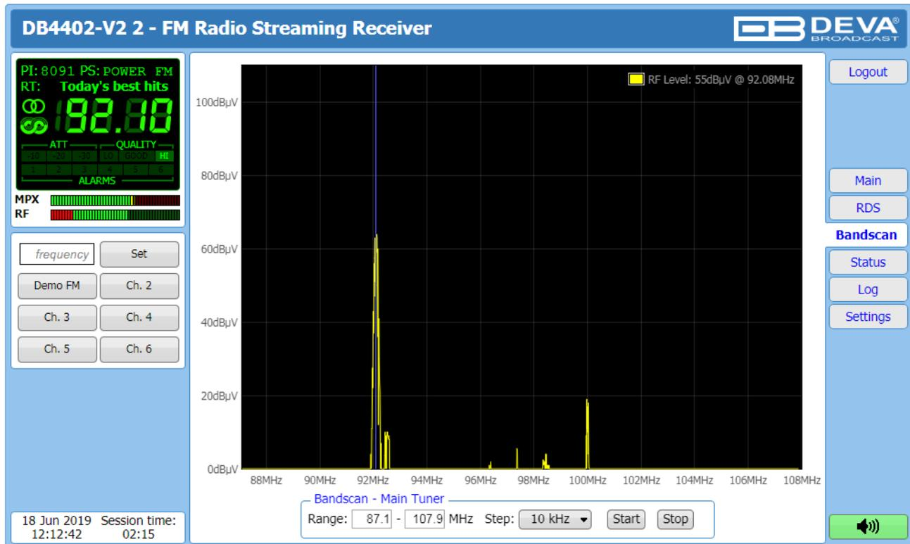
Esta pantalla evalúa la congestión de la banda de emisión FM barriendo el sintonizador a través de la banda FM, registrando cada portadora y generando una visualización del espectro del nivel de la portadora frente a la frecuencia.
