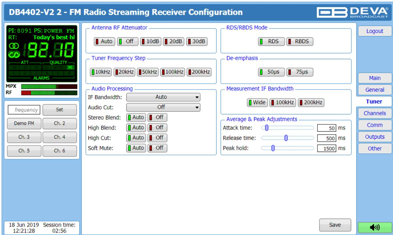
La sección del sintonizador ofrece un control total sobre los ajustes del sintonizador.
