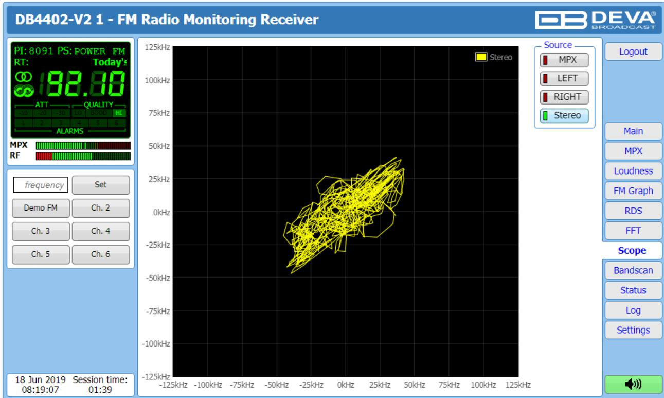
La pantalla Scope representa las señales que participan en el proceso de demodulación y decodificación estéreo a lo largo del tiempo. Para cambiar la fuente de la señal, se debe pulsar el botón correspondiente en el lado derecho del gráfico.
