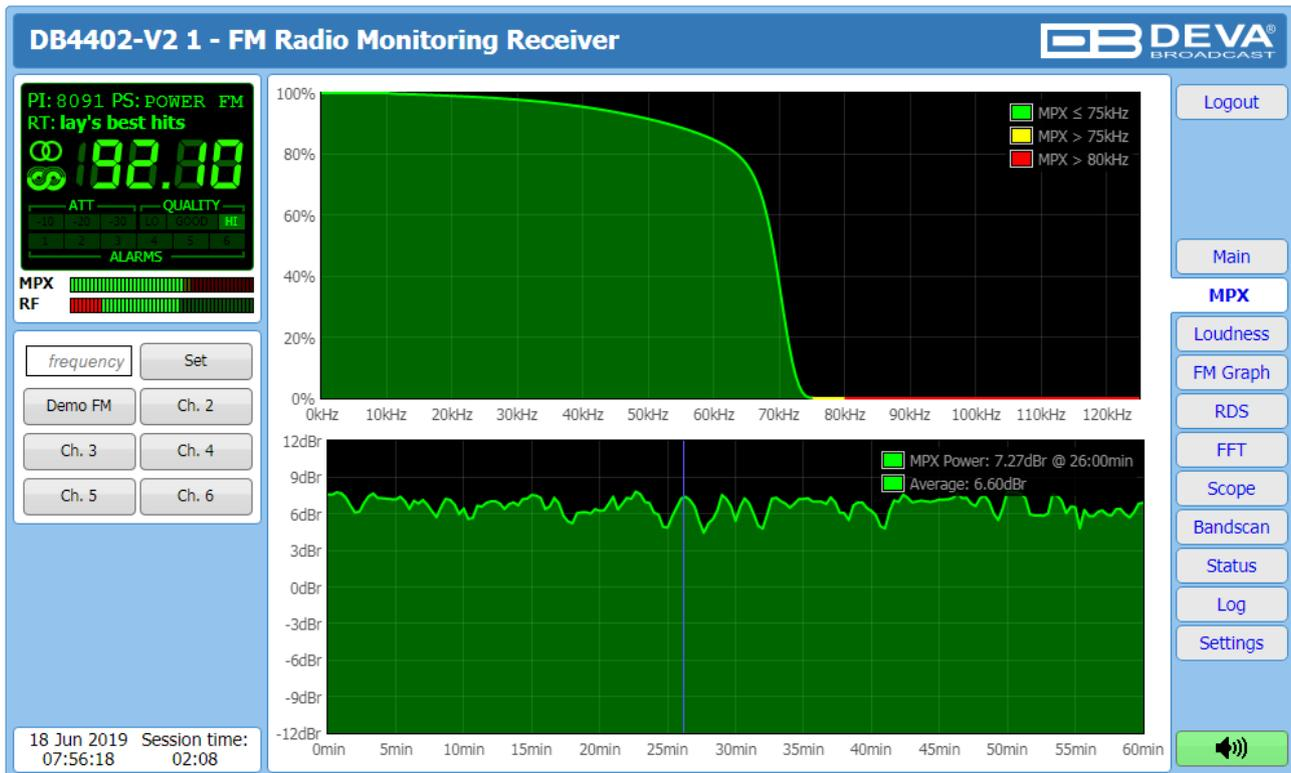
La página MPX muestra la desviación de la banda base MPX en función de la desviación en kHz durante el período de observación. El gráfico muestra inmediatamente la densidad de modulación.
