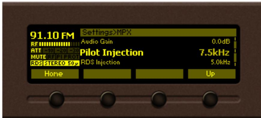
El DB7001 tiene incorporado un generador estéreo y un codificador de sistemas de datos de radio (RDS/RBDS). La cantidad de cada señal contenida en la señal MPX final se denomina nivel de inyección.
