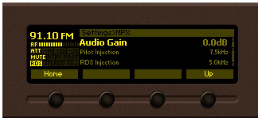
La señal MPX es una combinación de Audio, Piloto y Señal RDS. Esta opción permite ajustar la cantidad de cada señal incluida en el MPX. Los valores recomendados y por defecto son: **0dB Audio gain**, **7.5kHz Pilot** y **5.0kHz RDS**.
