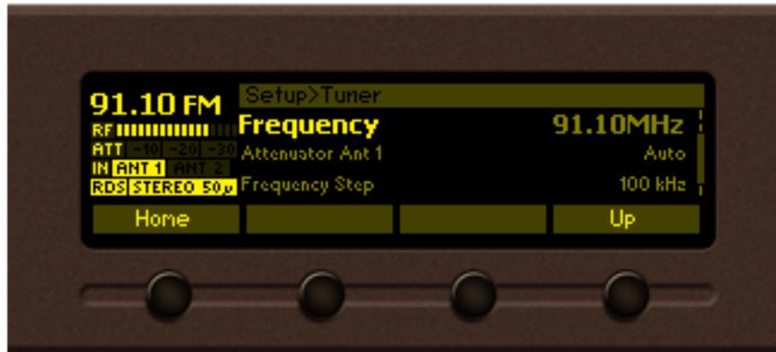
Estas configuraciones proporcionan todos los ajustes necesarios para el algoritmo que el DB7001 procesa la señal. A partir de aquí los ajustes aplicados a la estación **Principal** y de **Respaldo**, **PI Protection**, **Frequency Step**, **De-emphasis**, **RDS Mode**, **Audio Processing** y **Average** y **Peak** (utilizado para fijar los tiempos de respuesta de los indicadores) podría aplicarse.
