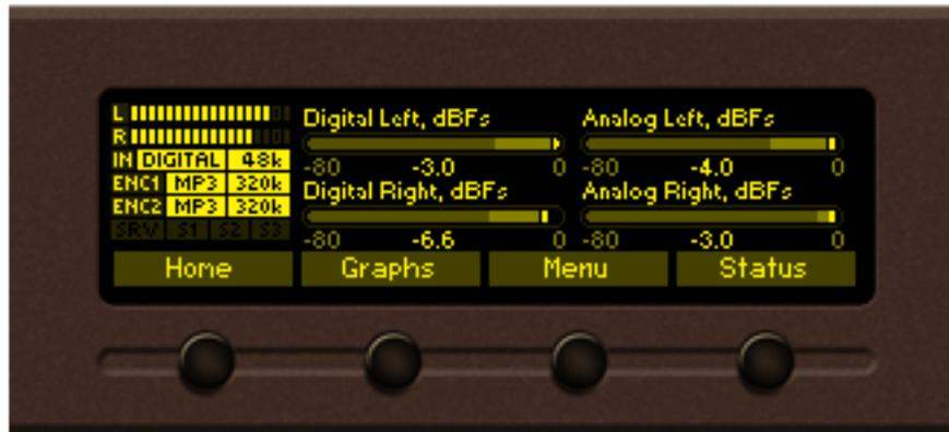
Страница уровней отображает индикаторы различных параметров измеряемых DB9009-TX. Параметры показаны в группах по 4. Каждый индикатор показывает моментальные значения с выделенным числом, минимальными и максимальными пиковыми значениями. Затемненными значениями показаны границы измерений. Название и единицы измерений параметра показаны над индикатором.
